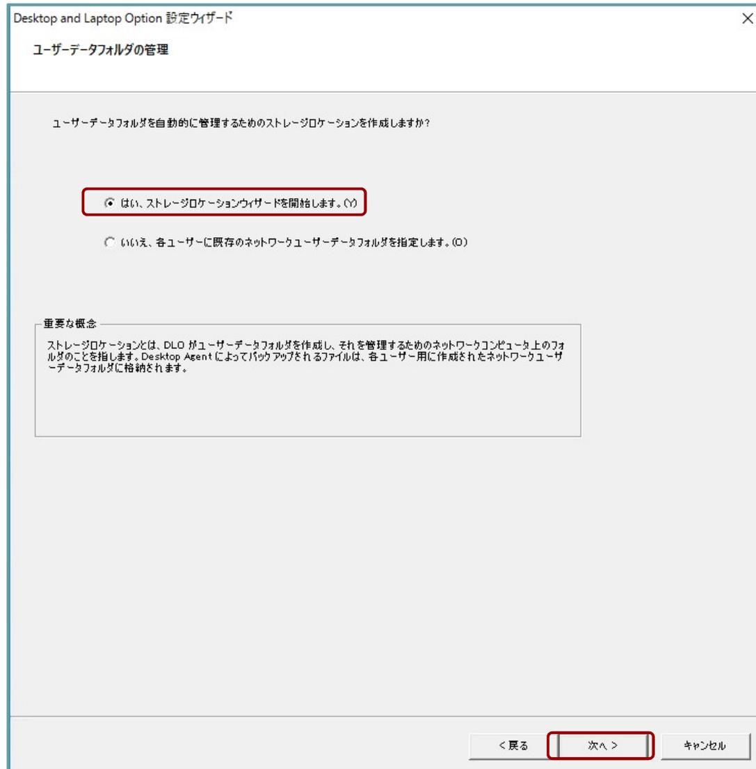
次にユーザデータを格納するためのストレージロケーションの設定を行います。「ストレージロケーションウィザードを開始します」を選択し、「次へ」をクリックします。
